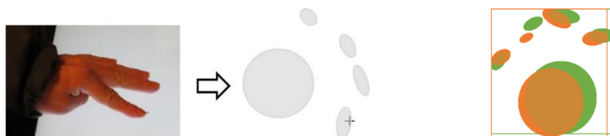
Figura 23. Prima extensie a algoritmului de clasificare a gesturilor ȘP (Vatavu et al. , 2012), denumită SmartTouch , extinde funcționarea algoritmului ȘP pentru gesturi reprezentate prin “elipse de atingere” care sunt clasificate folosind o nouă măsură a disimilarității.
