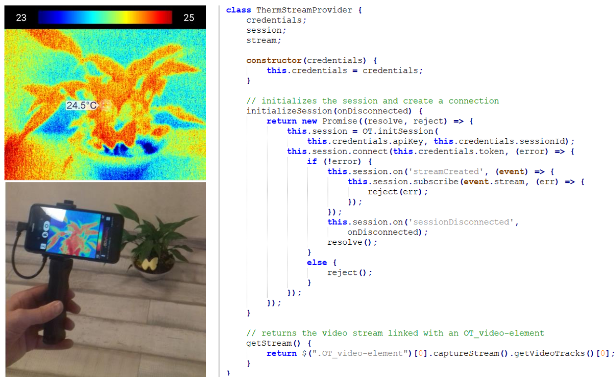
Figura 17. Imagine achiziționată folosind o cameră în domeniul termic conectată la un telefon smart (stânga) și secvența de cod JavaScript pentru transmiterea imaginii către clienți conectați (dreapta).
