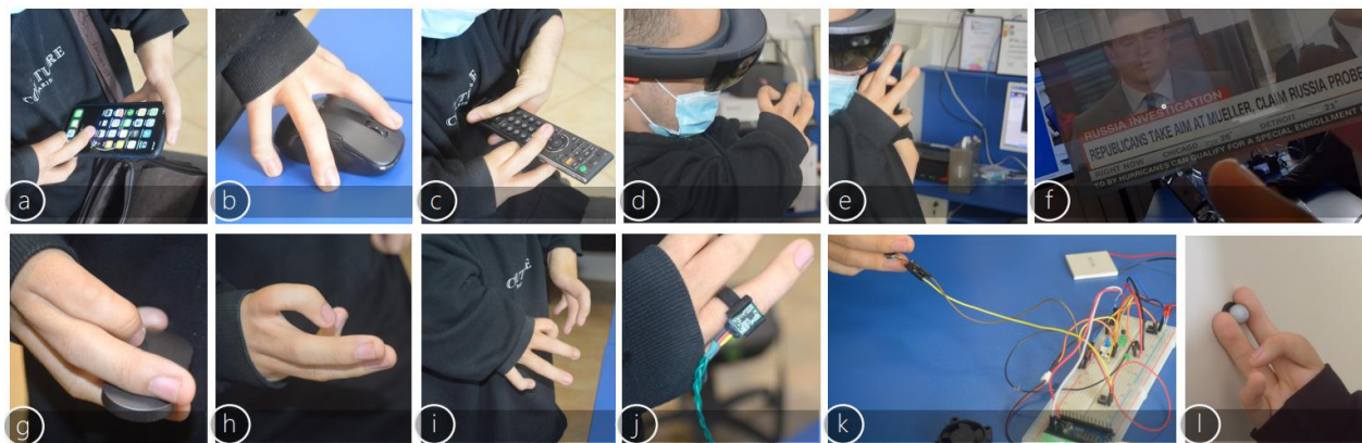
Figura 6. Studiu cu un participant cu dizabilități motorii efectuat pentru evaluarea proiectării bazate pe mediarea abilităților în cadrul SRs: (a-c) probleme de accesibilitate în folosirea telefonului, mouse-ului și telecomenzii TV; (d-f) încercări eșuate de a realiza gestul “air-tap”, implicit în HoloLens; (g) folosirea cu succes a HoloLens Clicker; (h) postură a mâinii demonstrând folosirea unei telecomenzi imaginare; (i) telecomandă TV imaginară folosită cu două mâini; (j) augmentarea degetului cu un accelerometru integrat într-o formă de inel tipărit 3D; (k) diverse modalități de feedback (aer, vibrații, termic) pentru a susține modelul telecomenzii imaginare; (l) plasarea precisă a unui marker Vicon pe un perete.
