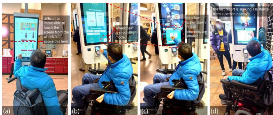
Figura 15. Probleme de accesibilitate a ecranelor publice pentru utilizatori ai scaunelor cu roțile: partea superioară a ecranului (a) nu poate fi atinsă confortabil și, chiar dacă unele ecrane au funcții de accesibilitate (b), acestea generează noi probleme (c), ceea ce conduce la solicitarea asistenței (d).
