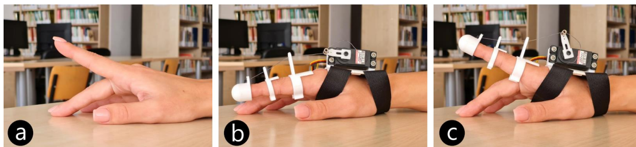
Figura 9. Prototipul Fingerhints implementează feedback kinestezic pe deget (a) introducând un limbaj descriptiv și un spațiu de proiectare corespunzător unor astfel de interacțiuni. Fingerhints valorifică forța mecanică a unui servomecanism pentru a oferi utilizatorului informații (e.g., notificări) exclusiv prin mișcarea degetului arătător, de exemplu, de la o extensie subtilă (b) la una alertă (c).
