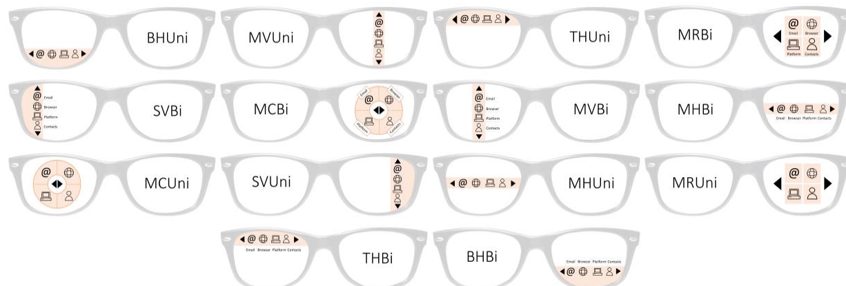
Figura 6. Cele 14 viniete folosite în cadrul studiului de solicitare a preferințelor, viniete informate de spațiul de proiectare din figura 5. Fiecare vinietă este codificată folosind locația (T - top, B - bottom, S - side, M - middle), orientarea (H - horizontal, V - vertical, C - circular, R - rectangular) și modalitatea de prezentare a opțiunilor (Uni - unimodal icons, respectiv Bi - bimodal text/icons).
