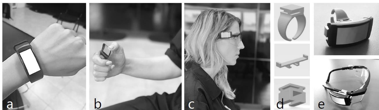
Figura 8. Prototipuri de dispozitive pentru achiziția gesturilor. Notă: ecranul tactil a fost purtat la încheietura mâinii (a), pe deget (b) și atașat de rama unor ochelari (c) cu suporturi tipărite 3D (d,e).
