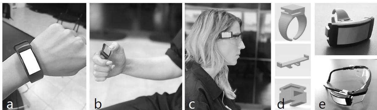
Figura 2. Prototipuri folosite pentru achiziția gesturilor de atingere și mișcare. Notă: ecranul Samsung Gear Fit 2 a fost purtat la încheietura mâinii (a), pe deget (b) și atașat de rama unei perechi de ochelari (c) folosind suporturi tipărite cu ajutorul unei imprimante 3D (d,e).
